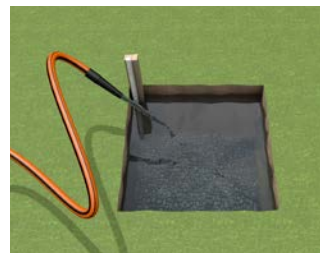
Rys. 1-4 Napęczenie wykopu wodą
